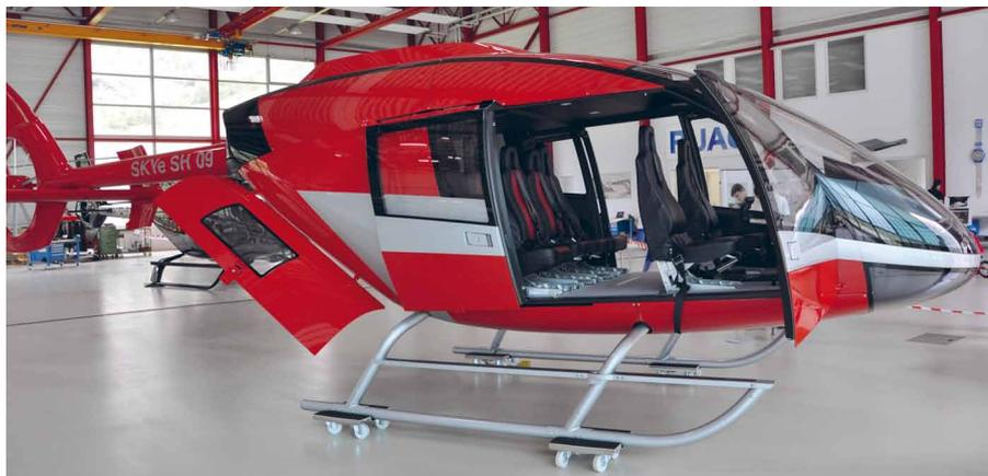
Eine grosse Kabine, ein flacher Boden, geräumige Schiebe- und Heck-Türen, eine sehr gute Aussensicht und flexible Konfigurationen sind einige Besonderheiten dieses innovativen Mehrzweck-Helikopters.
