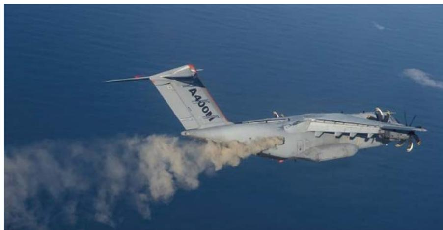
Eine Tonne Vulkanasche, zerstäubt von einer A400M in 10'000 Fuss Höhe (zvg)
