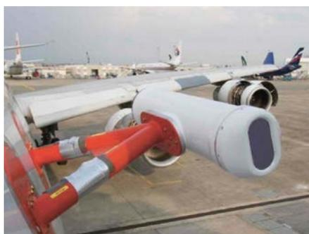
Der AVOID-Sensor am Rumpf eines A340 Airbus (zvg)
